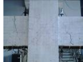
(b) Buka tutup celah di sambungan dissipater sampai drift 2.2%
