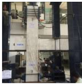
(e) Set up benda uji eksterior
