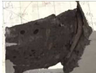
(e) Kondisi dissipater pada drift 3.5%
