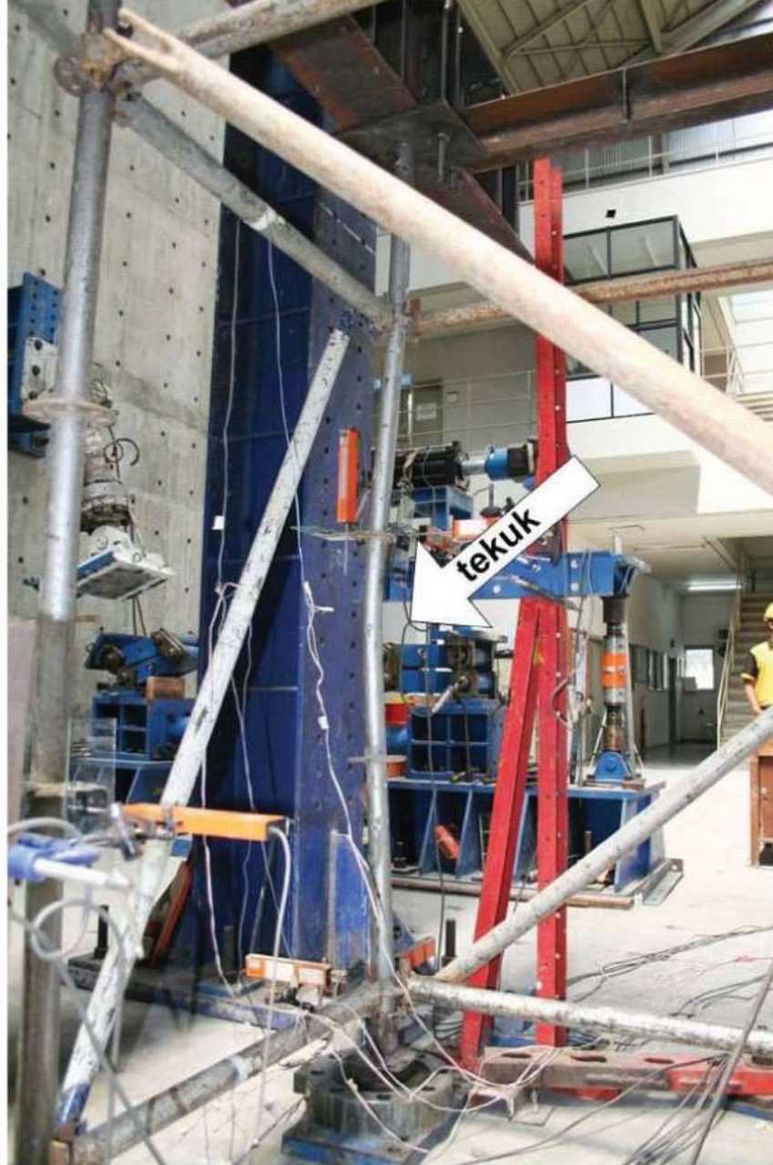
Gambar 22. Bentuk kerusakan pada scaffolding uji (Dewobroto 2013a)
