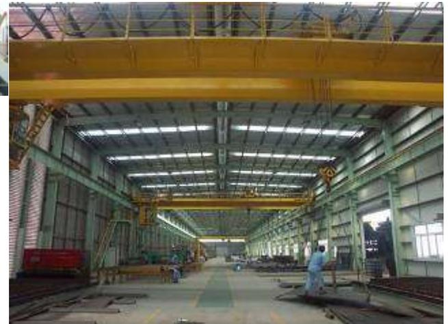
Workshop fabrikasi minimal ada alat angkat (*crane*), untuk yang modern ada mesin CNC, untuk memotong atau melubangi profil dengan kontrol komputer untuk menjamin tingkat presisinya.
